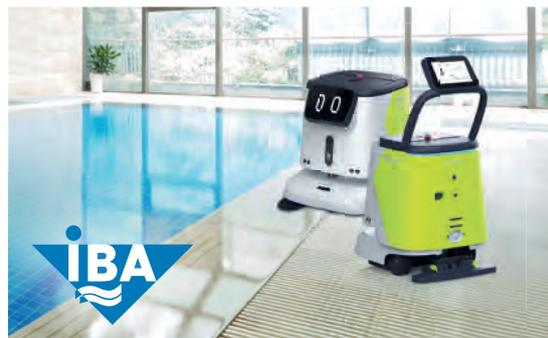
700 m<sup>2</sup> pro Stunde, Tag und Nacht. Dieses Multifunktionsgerät ist sowohl vollautomatisch als auch manuell für Aufgaben wie schrubben oder saugen einsetzbar. Sensorisch ausgestattet mit LIDAR, Ultraschallradar, RGB-Kamera und Laser navigiert der Roboter präzise durch komplexe Raumstrukturen. Wird eine Servicestation mit eingebunden, entleert, befüllt und lädt sich das Gerät selbst-
