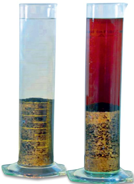
12 Ergebnis der Reinigung gebrauchter Filtrationsmaterialien mit Wasser (links) und speziellem Reinigungsmittel; Quelle: Dr. Nüsken Chemie
